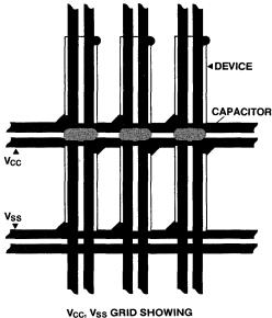
V<sub>CC</sub>, V<sub>SS</sub> GRID SHOWING DECOUPLING CAPACITORS
