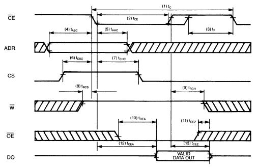
EARLY-WRITE CYCLE ( $\overline{OE} \ge V_{IH}$ ,  $\overline{RFSH} \ge V_{IH}$ )
